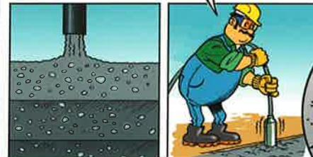
BEIM BETONIEREN HOHER BAUTEILE IST LAGENWEISE EINZUBAUE. JEDE SCHICHT  $\leq 50$  CM
